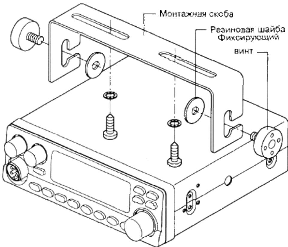
Рис. 2. Крепление радиостанции при помощи монтажной скобы.
